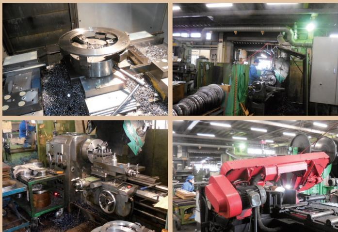
れた鉄板などの生素材から、製品図面をもとに素材をカットしたり穴をあけたりして、基本の形をつくり出します。工場内でフル稼働する大型機械とそれを操作し作業する方の手を通して、切削加工を施し成形。焼き入れと呼ばれる熱処理の作業は、東洋刃物熱処理工場に運ばれて行われます。焼き入れをすることにより硬度が増し、表面が黒くなった状態で再び工場に戻ってきた刃物は研削作業へ。刃を研ぎ出し表面を研磨しピカピカに仕上げた完成。切れ味鋭い刃物となって納品されるというのが、一連の流れです。
